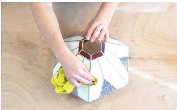
**25** Placez le chapeau de laiton en haut de l'abat-jour en veillant à ce que l'hexagone soit bien centré, puis réalisez des points de soudure sur les sommets. Chauffez assez longtemps pour que l'étain prenne sur le laiton.
